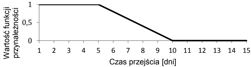
Rysunek 5.1 Funkcja przynależności dla czasu przejścia w procesie produkcji
